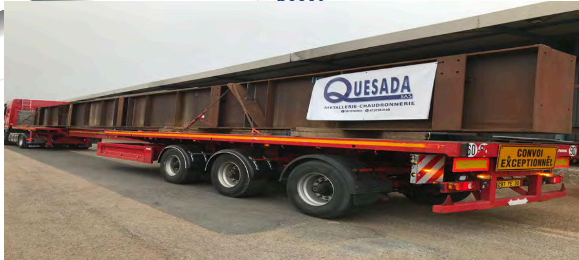
Transport en convoi exceptionnel d'une poutre métallique 25m
